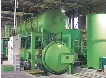
AZN処理(乾式加圧注入防腐・防蟻処理工法)装置
