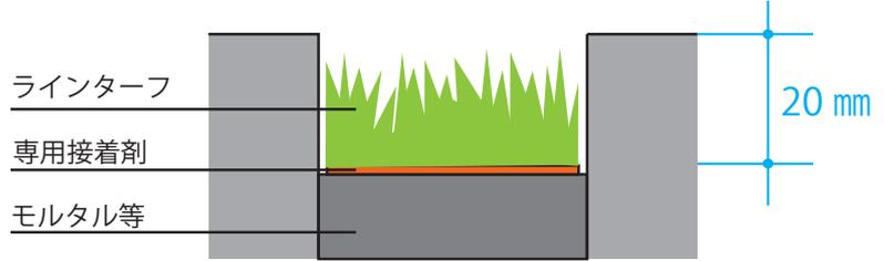
【ラインターフ施工断面図 正面】
