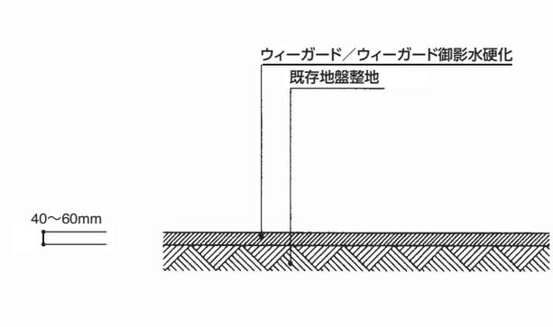
施工断面図（軟弱地盤用）
