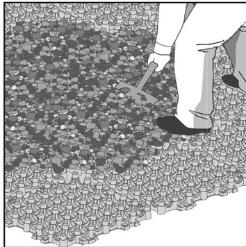
敷設完了後、突起間に砂利を入れ足等で締め固めて下さい。
