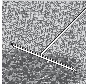
トンボ等で砂利の表面を平らに均して施工完了として下さい。
