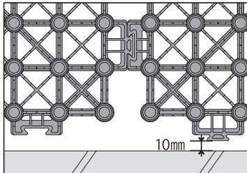
温度差による伸縮対策の為、ジョイント部のアソビは開いた状態で敷設して下さい。また、縁石等の固定物の周りは10mm程度の隙間を設けて下さい。
