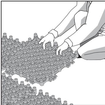
路盤上の一角より、施工して下さい。ジョイント部を上から押し込むだけの簡単施工です。
