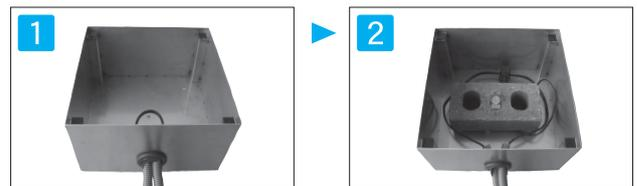
穴ふさぎゴムに切り込みを入れ、CD管を挿入し配線します。単体設置時のCD管は1本ですが、複数または連結設置時は2本になります。
