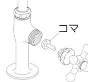
3 上部にコマを差し込み、本体に取り付け締め付けます。
